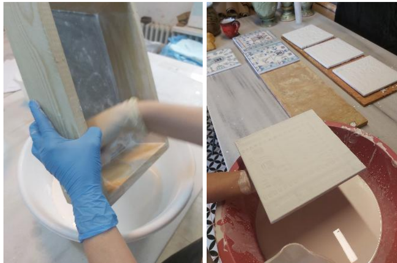
Görsel 14 Çini karoların sırçasının sulandırılması, süzülmesi ve uygulama işlemi. Sırça, maşrapadan çini karo üzerine akılarak yüzey sırça ile kaplanmıştır. Bir gece kuruduktan sonra fırına yerleştirilmiştir, (Kaynak: Ergün Arda).
