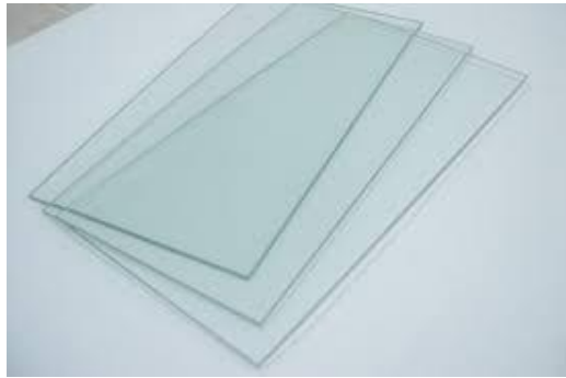
Görsel 16 25x50cm ölçüsünde ve 3mm kalınlığında düz, şeffaf cam plakalar (Kaynak: Ergün Arda).
