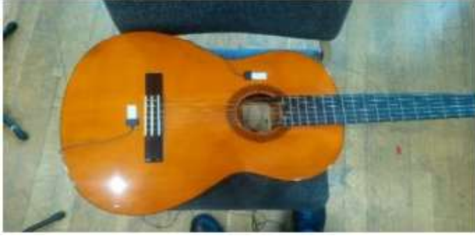
Şekil 6. Sensörlerin gitar gövdesine yerleştirilmesi (Ekmen, 2020)
