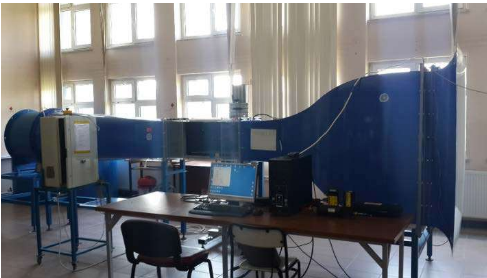
Şekil 4. Emme tipi rüzgâr tüneli test düzeneği
