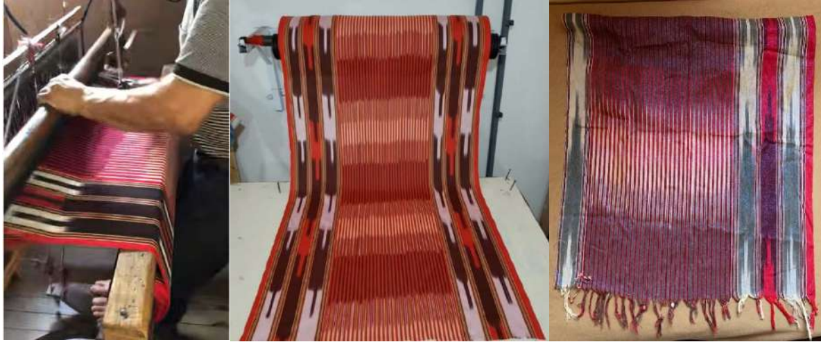
Görsel 3. Kamçılı mekikli dokuma tezgahında keşan dokuma ve tezgahtan çıkarma
