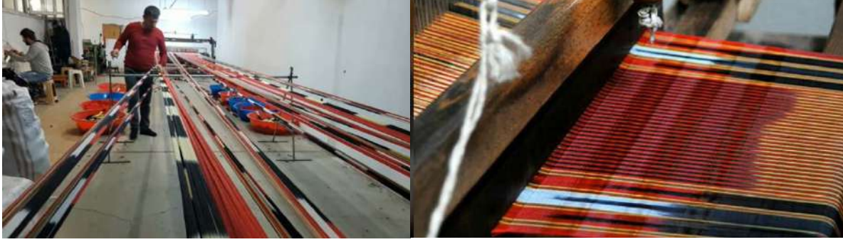
Görsel 2. Çözü çekme ve dokuma tezgahına yerleştirme
