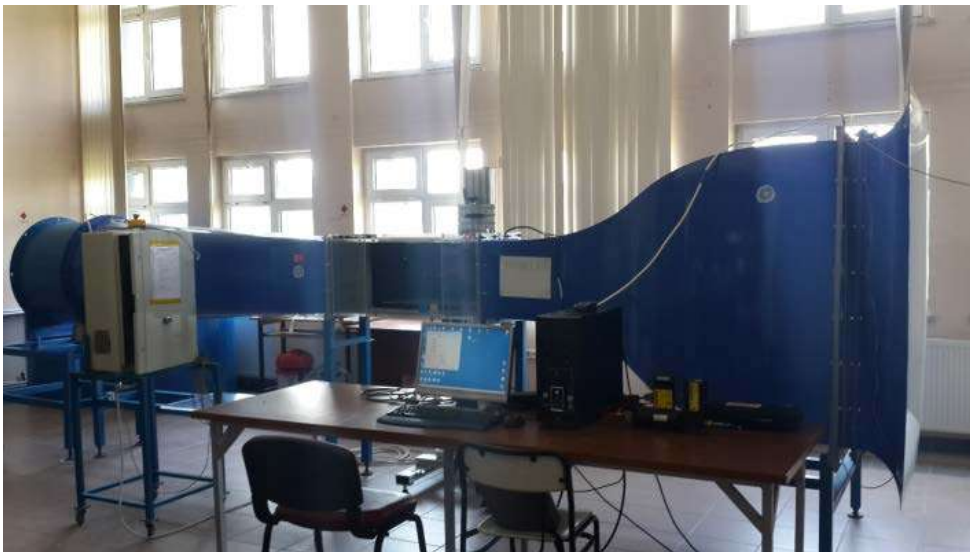
Şekil 4. Emme tipi rüzgâr tüneli test düzeneği
